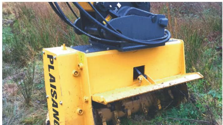
Для работы с мульчером экскаватор должен быть оснащен дополнительным гидровыходом.
