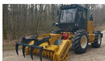
Мощность 260 л.с. Помимо лесной фрезы оснащен манипулятором с дисковым обрезчиком веток. Предназначен для удаления древесно-кустарниковой растительности диаметром до 30 см. на корню и утилизации порубочных остатков диаметром до 40 см., обрезки суков и ветвей на деревьях диаметром до 15 см. Идеален для обслуживания полос отвода линейных объектов (ЛЭП, трубопроводы, дороги) вне населенных пунктов, ухода за лесными делянками, для создания противопожарных полос.
