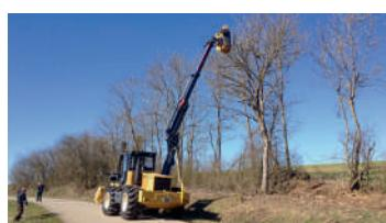
Мощность 320 л.с. Предназначен для удаления древесно-кустарниковой растительности диаметром до 40 см. на корню и утилизации порубочных остатков диаметром до 45 см.
