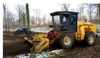
Мощность 440 л.с. Предназначен для удаления древесно-кустарниковой растительности диаметром до 45 см. на корню и утилизации порубочных остатков диаметром до 55 см. Идеален при прокладке просек при строительстве линейных объектов (ЛЭП, трубопроводы, дороги), подготовке площадок под строительство, для работ по расширению полос отвода линейных объектов.
