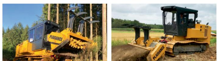
Мощность 440 л.с. Предназначен для удаления древесно-кустарниковой растительности диаметром до 50 см. на корню и утилизации порубочных остатков диаметром до 60 см. Идеален при прокладке просек при строительстве линейных объектов (ЛЭП, трубопроводы, дороги), подготовке площадок под строительство, для создания противопожарных полос, для работ по расширению полос отвода линейных объектов.
