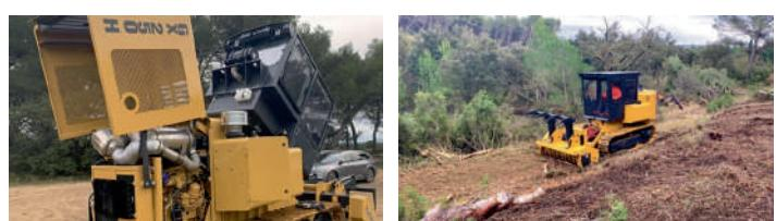
Мощность 270 л.с. Предназначен для удаления древесно-кустарниковой растительности диаметром до 30 см. на корню и утилизации порубочных остатков диаметром до 40 см. Идеален для обслуживания полос отвода линейных объектов (ЛЭП, трубопроводы, дороги) вне населенных пунктов, ухода за лесными делянками, для создания противопожарных полос.
